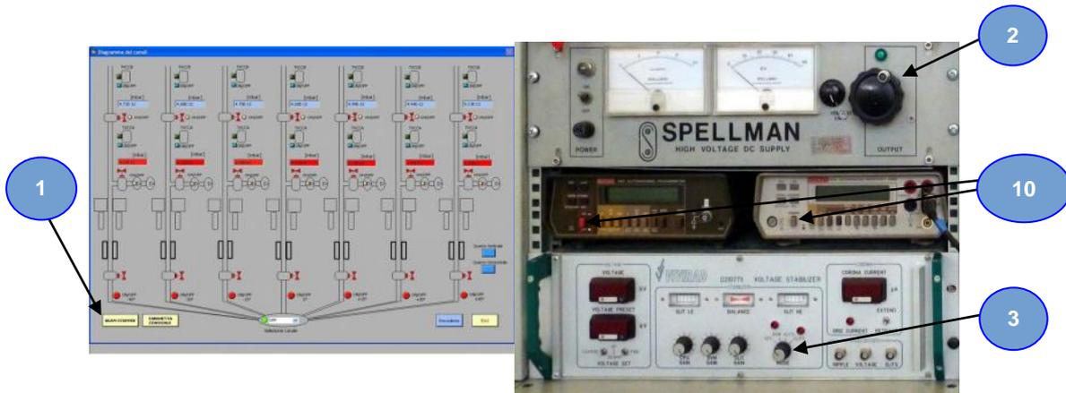
Fig. 2 b) : pannello del supervisore con il sinottico dei canali (e pulsante per attivare il BEAM STOPPER), foto del cassetto SPELLMAN, degli strumenti KEITHLEY e del cassetto di stabilizzazione.
