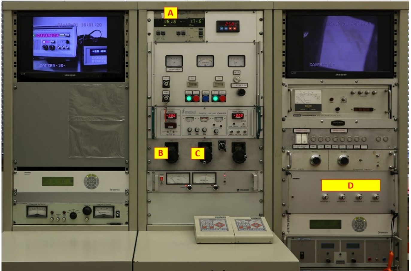
Figura 1: Consolle dell'acceleratore AN2000 con indicati gli attuatori e i lettori relativi alle operazioni descritte sopra.
