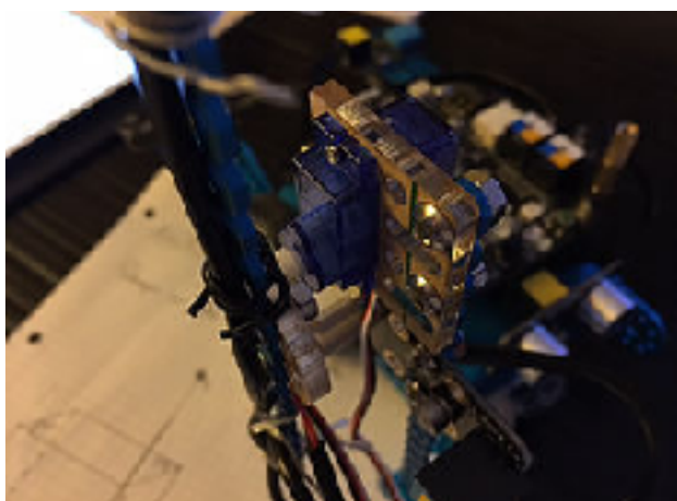
particolare del servo motore che gestisce la sonda di temperatura
