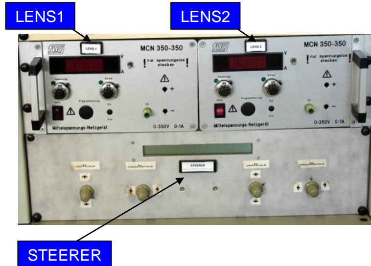
Figura 1a) console dell'acceleratore CN, con gli attuatori per le operazioni descritte in Allegato 1
