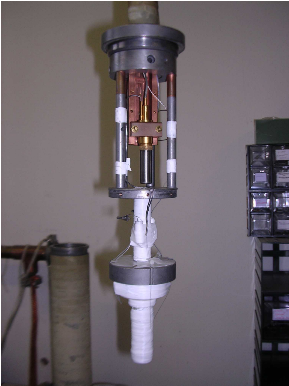
Figura 3.1: Foto dell'alloggiamento del risonatore e dello SQUID; sono visibili i due dischi di rame e le quattro colonne che formano la struttura portante dell'alloggiamento.
