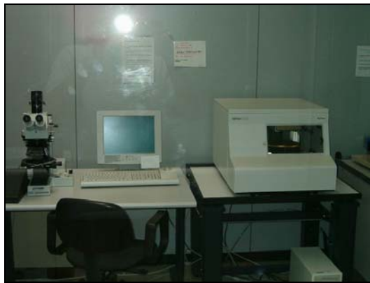
Figura 1-11 Profilometro (KLA-Tencor P-15 stylus profilometer) e relativo calcolatore per l'analisi delle acquisizioni.
