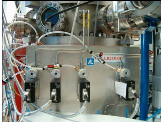
Figura 1-8 I 4 flussimetri collegati alle linee dei gas.
